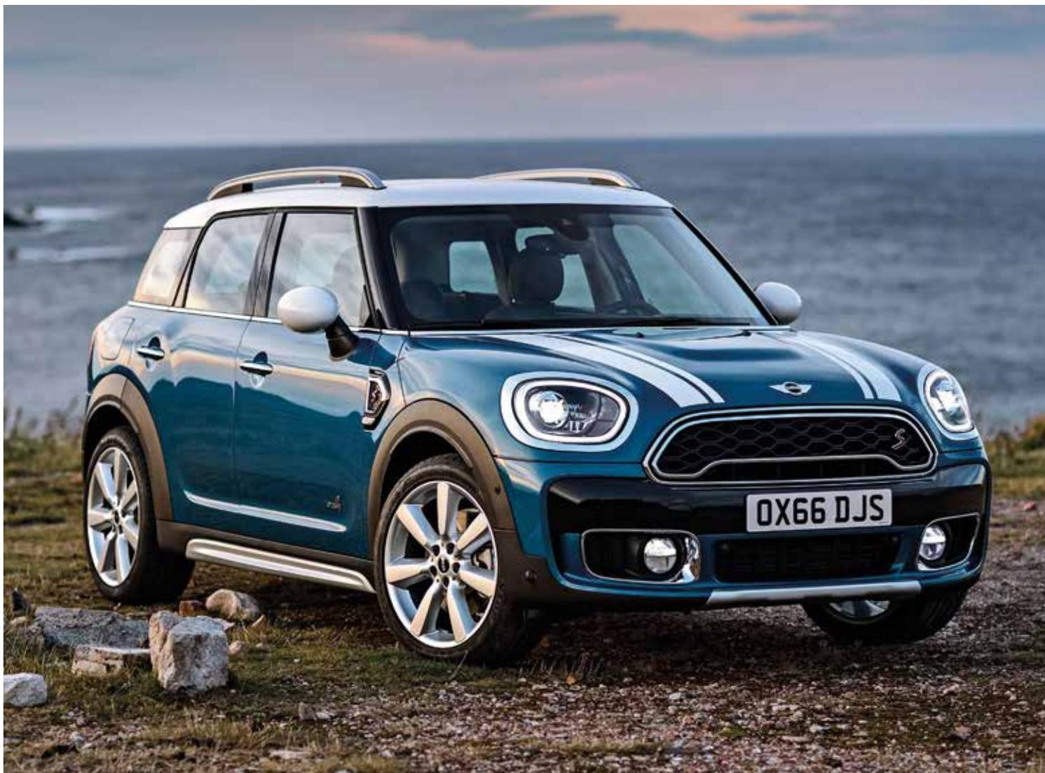
O Mini Countryman é equipado, em sua versão S, com o conhecido motor 2.0 turbo de 192 cv e 28,5 kgfm de torque e câmbio automático de oito velocidades. A segunda geração do crossover britânico é 20 centímetros mais longo e o entre-eixos de 2,66 metros é 7,5 centímetros maior do que o antecessor. No interior, destaca-se a tela de 8,8 polegadas sensível ao toque, com GPS integrado de série. O modelo conta com outras praticidades, como o freio de mão eletrônico. Mais informações na Welle Motors.
